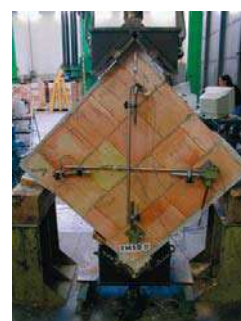
Prove di compressione diagonale
