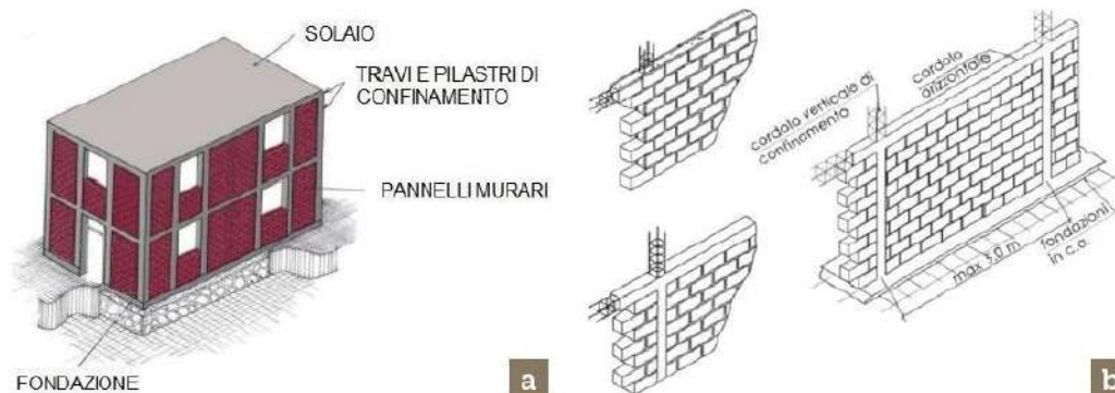
Edificio in muratura confinata: (a) struttura d'insieme e (b) dettagli costruttivi.
